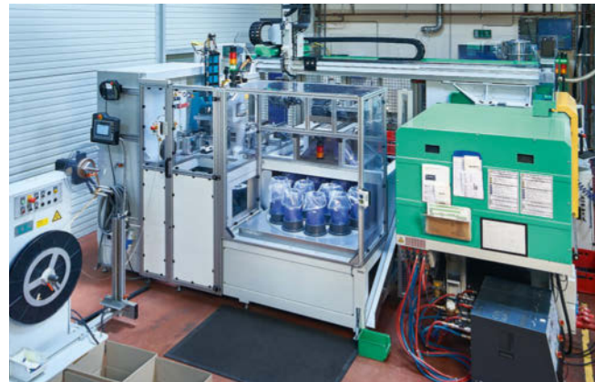
Mit der kompakten Turnkey-Anlage fertigt Goerlich Gehäuse für Unterdrucksensoren effizient und flexibel.
