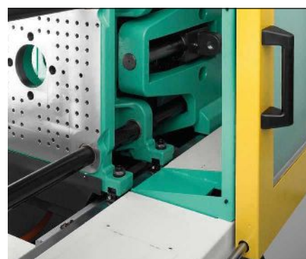
In alto: la calotta di protezione maggiorata offre più spazio sul retro.
