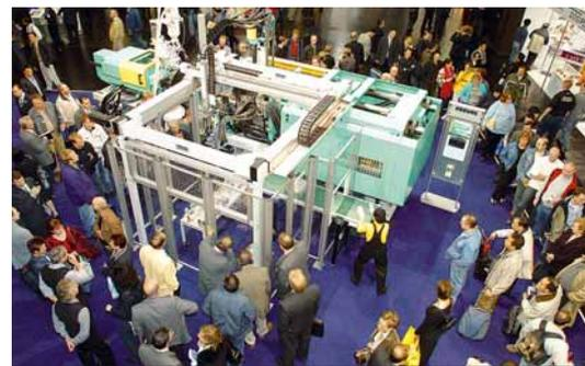
centrale delle ALLROUNDER U crea rapporti simmetrici della forza nel gruppo chiusura stampo e garantisce la massima precisione. L'impianto idraulico, sistemato in prossimità delle utenze, sia sul lato iniezione che su quello chiusura, consente un'ottimale possibilità di regolazione degli assi di comando con conseguente massima precisione.
