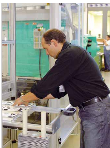
Il pezzo stampato luminoso (in alto) scaturisce dall'iniezione posteriore di un film speciale, inserito in manuale in cassette (in basso).
