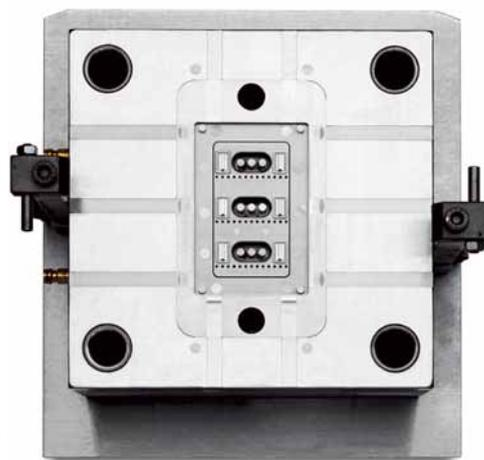
varianten durch Überlauf- oder Unterflurkanäle. Der Überlaufkanal verhindert Lufteinschlüsse an Fließfronten und in Bindenähten. Die Zusammenfließstelle wird einfach aus der Kavität hinaus verlagert. Ein Unterflur-Entlüftungskanal wird immer dann eingesetzt, wenn es Formteilgestaltung, Kühlkanalführung oder durch Entlüftungstempel entstehende Oberflächenmarkierungen erforderlich machen. Ausgeführt ist ein solcher Unterflurkanal wie ein Stück Tunnelanguss mit Punktanschnitt und Auswerfer.
