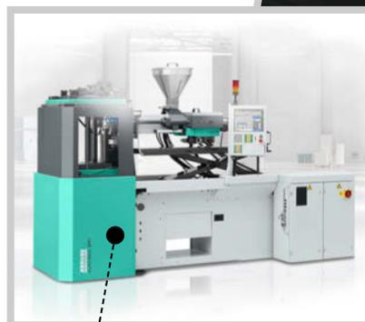
Principe ALLROUNDER (option) : l'unité de fermeture pivotante offre encore plus de diversité d'applications.
