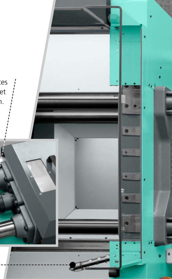
Unité d'injection pivotante : possibilité de retirer la vis sans démonter l'ensemble de plastification.
